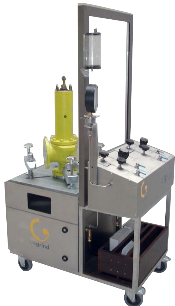
TS 10 M-H mit Luft- und Wasserprüfung
