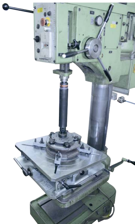
Наклонный стол UNT 2 + адаптер, шлифование клина задвижки
