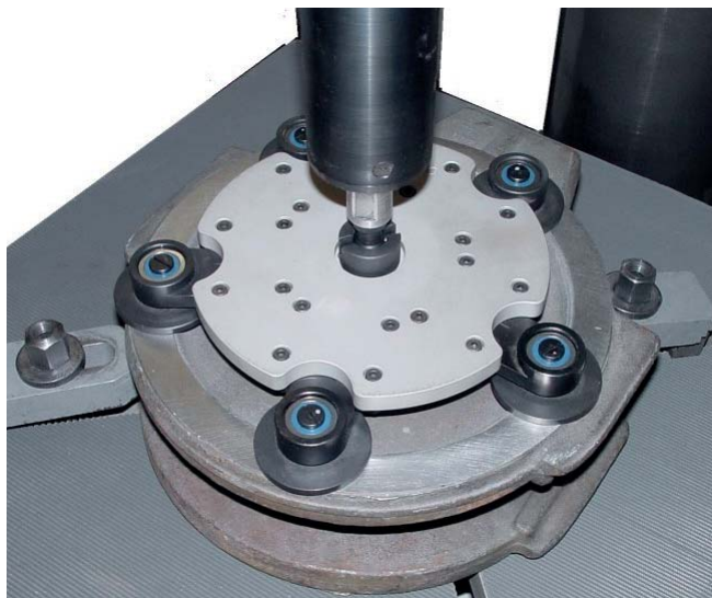
Шлифование клина задвижки планетарным шлифовальным диском
