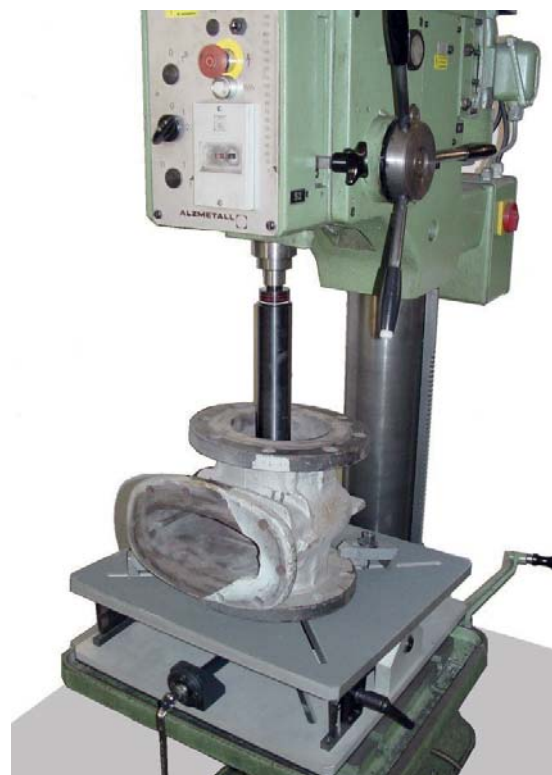
Наклонный стол UNT 2 + адаптер, шлифование седла задвижки
