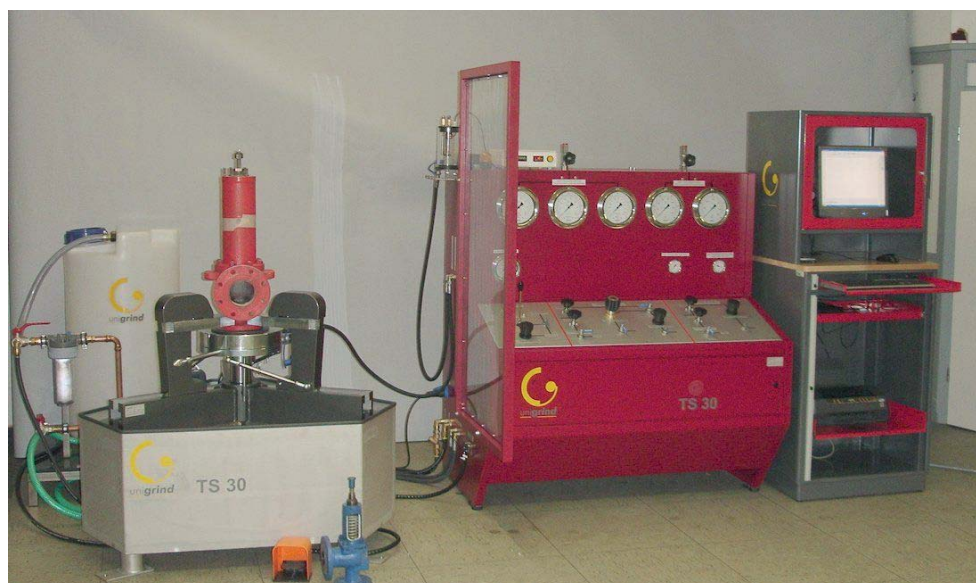
Испытательный стенд TS 30 с системой сбора и обработки цифровых данных
