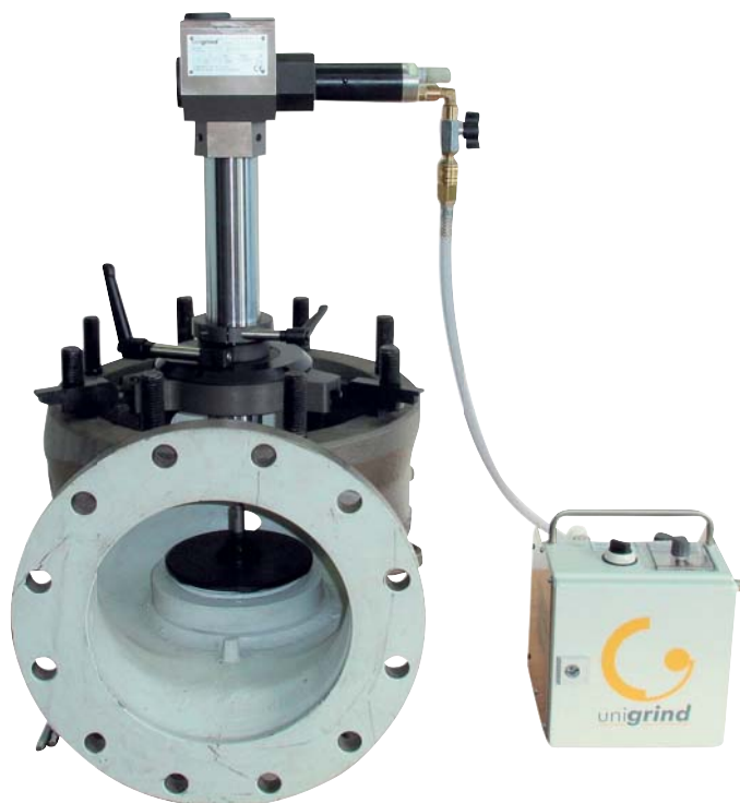
Станок SVS 1 установлен на предохранительном клапане
