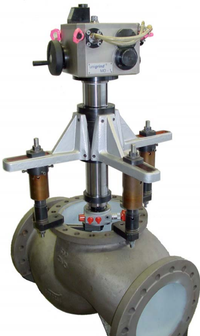
Обработка седла вентиля при помощи станка MD 1
