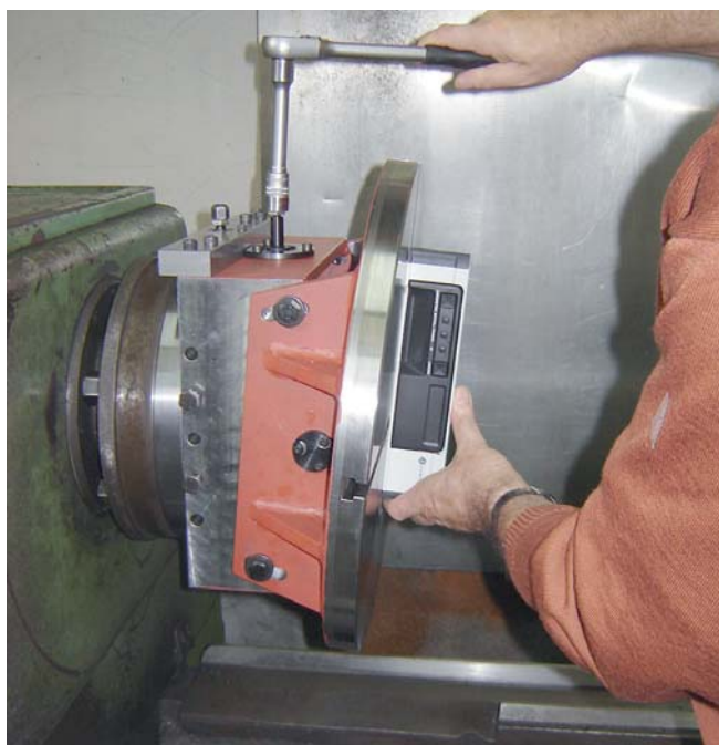
Регулировка угла наклона при помощи цифрового измерительного прибора
