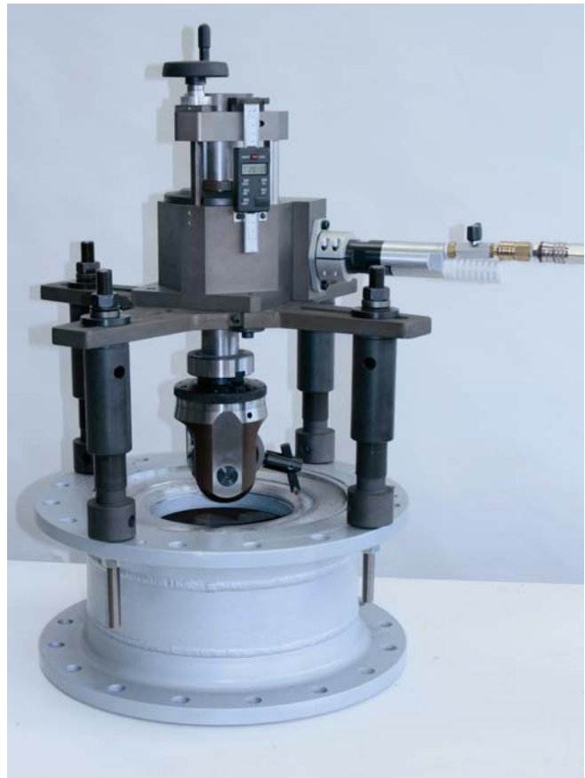
Станок MD 250 с расточной головкой для обработки конических отверстий
