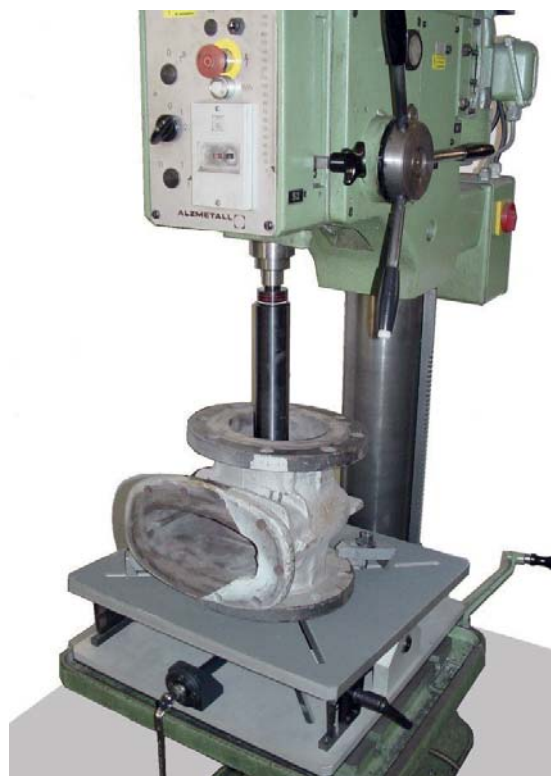
UNT 2 + Adapter, Schleifen eines Schiebergehäuses
