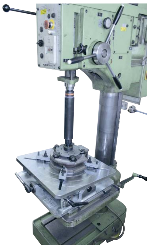
UNT 2 + Adapter, Schleifen eines Schieberkeiles
